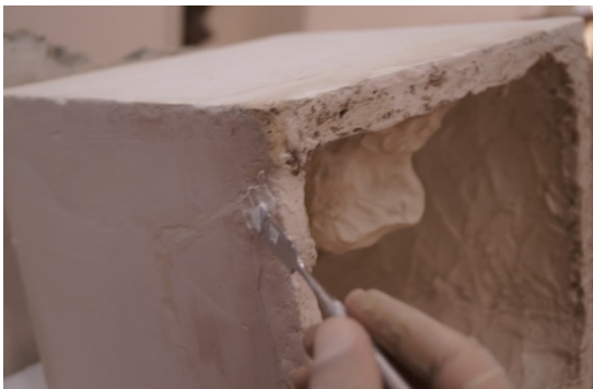
Figura 15. Reconstitución del soporte, utilizando la masa de consolidación en yeso rápido e adhesivo PVA en agua destilada 1:1.
